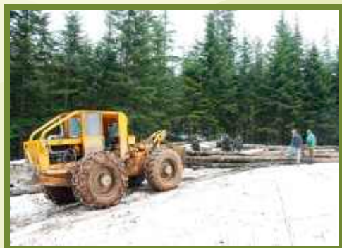
Zdj. 14 Ciągnik zrywkowy LKT – sprawdza się dobrze w terenie górskim, zwłaszcza w starszych drzewostanach (Zdj. Bogusław Pawłowski)
